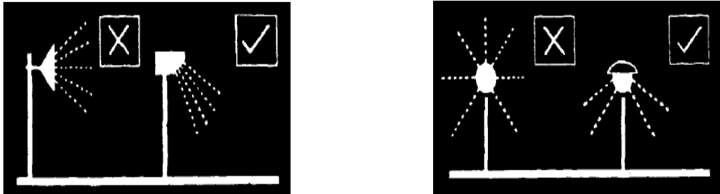
شکل ۲-۱۱: استفاده از تجهیزات روشنایی خاص به منظور کاهش نور پراکنده شده
