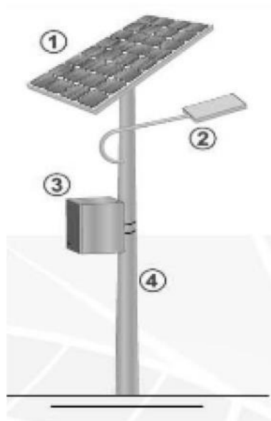
شکل ۱۴-۳: اجزای سیستم روشنایی راه خورشیدی
