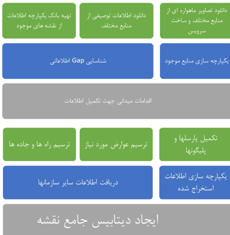
شکل ۷-۲: مراحل تشکیل پایگاه داده جامع نقشه پایه مجموعه وزارت نیرو
